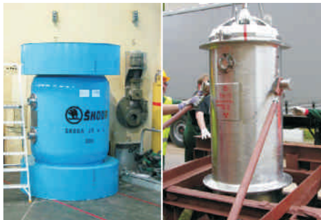
Pojemniki transportowe na wypalone paliwo, wykorzystane do wywozu wypalonego paliwa z reaktorów EWA i MARIA zlokalizowanych w Świerku
