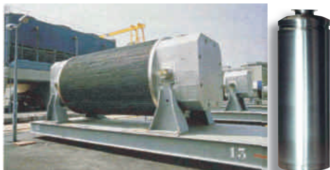
Z prawej kanister na zeszkliwione wypalone paliwo. Typowy rozmiar: wysokość 1,3 m, średnica 40 cm. Obok pokazany jest pojemnik transportowy przeznaczony do przewożenia wypalonych elementów paliwowych
