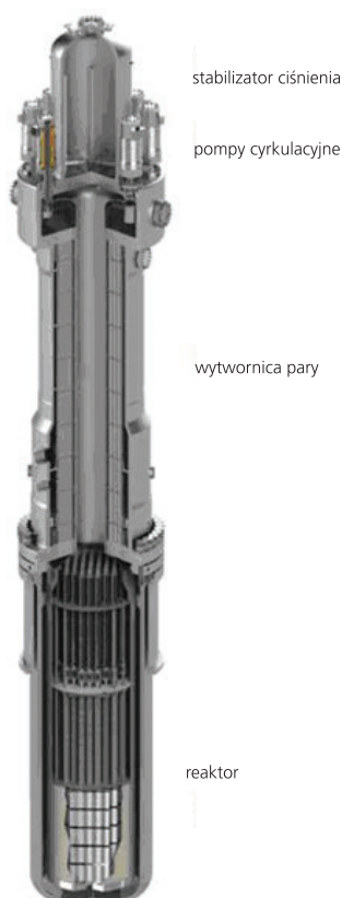
Rys. 41. Przekrój przez reaktor mPower (źródło: materiały B&W)
