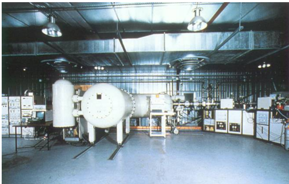
Rys. 5.19 Spektrometr mas służący do określania stosunku ^{14}\text{C}/^{12}\text{C} w badanej, kilkumiligramowej próbce
