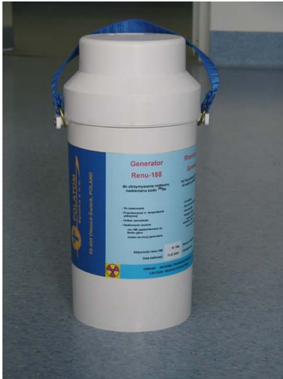
Rys. 6.5 Generator renu ( ^{188}Re ) oraz przekrój przez generator technetu ( ^{99m}Tc ), produkowane przez POLATOM, Świerk
