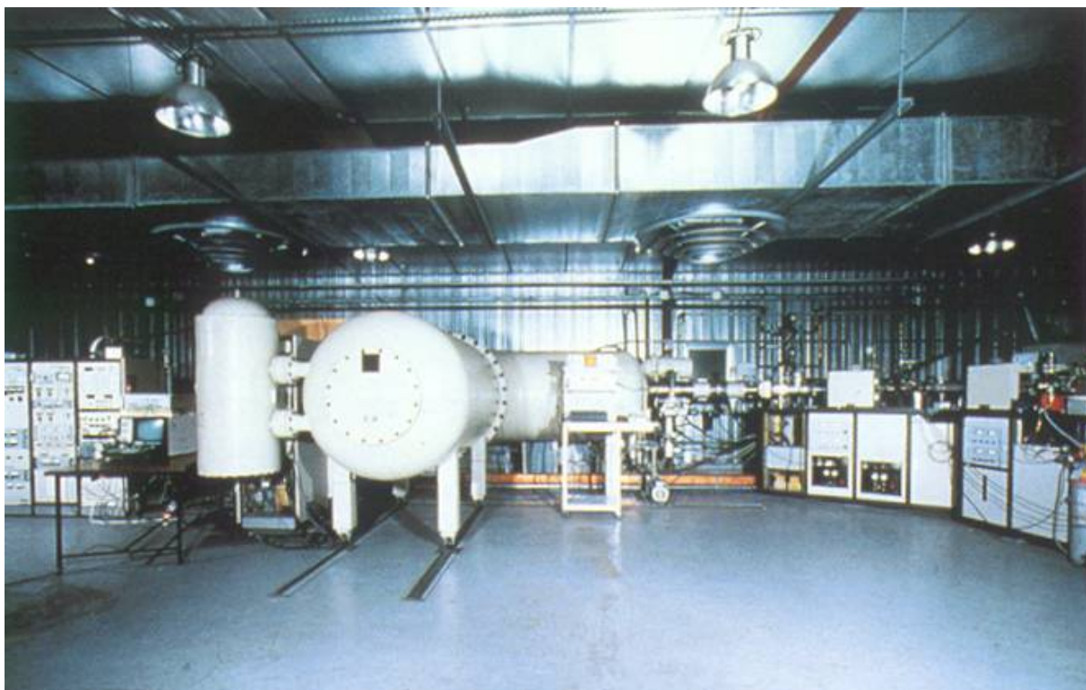
Rys. 18.19 Spektrometr mas służący do określania stosunku ^{14}\text{C}/^{12}\text{C} w badanej, kilkumiligramowej próbce
