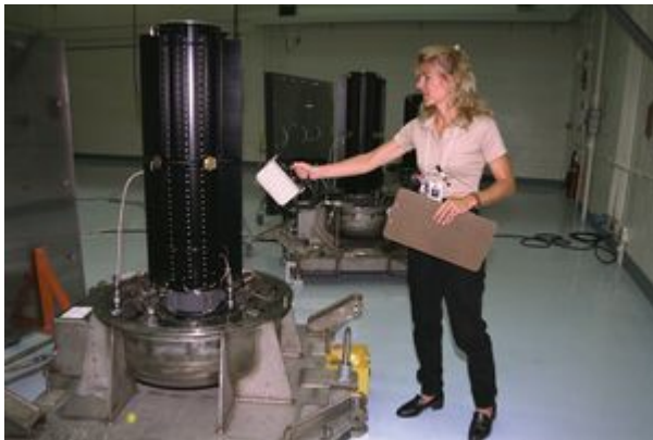
Rys. 17.4 Sprawdzanie poziomu promieniowania (mocy dawki) wokół radioizotopowego generatora termoelektrycznego dla sondy Cassini (zdjęcie z http://wikipedia.com )
