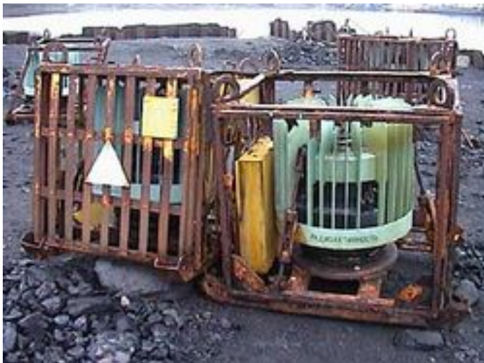
Rys. 17.5 Niemal całkowicie zniszczony radioizotopowy generator termoelektryczny pracujący w oparciu o źródło ^{90}\text{Sr} (zdjęcie z http://wikipedia.com )
