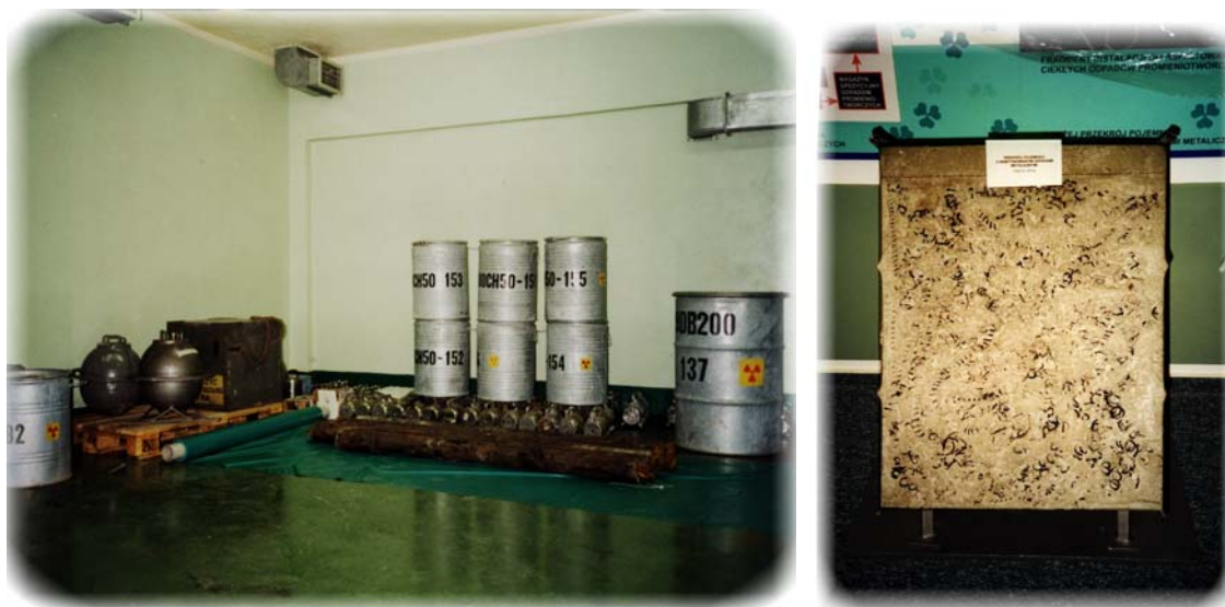
Rys. 9.4 Komora z pojemnikami (hobokami) oraz przekrój pojemnika zawierającego metaliczne odpady promieniotwórcze
