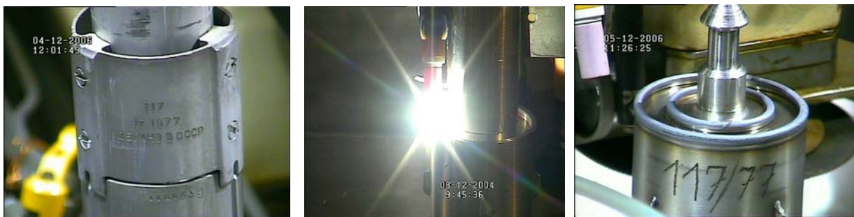
Rys. 9.12 Od lewej do prawej: zestaw paliwowy wkładany do kapsuły, spawanie kapsuły z zestawem paliwowym. Zamknięto już 144 zestawy (około 50% ) i połowę z nich wywieziono do przechowalnika paliwa poza reaktorem
