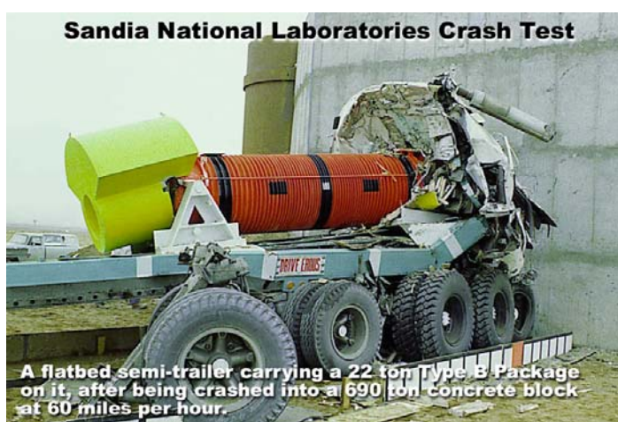
Rys. 9.25 Test zderzeniowy dla ciężarówki wiozącej pojemnik o ciężarze 22 ton, zderzający się przy prędkości ok. 100 km/godz ze ścianą betonową ważącą 690 ton.
