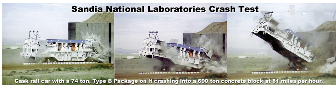
Rys. 9.23 Przebieg testu zderzeniowego pojemnika typu B na lorze kolejowej o wadze 74 ton ze ścianą betonową ważącą 690 ton przy prędkości pociągu ok. 130 km/godz
