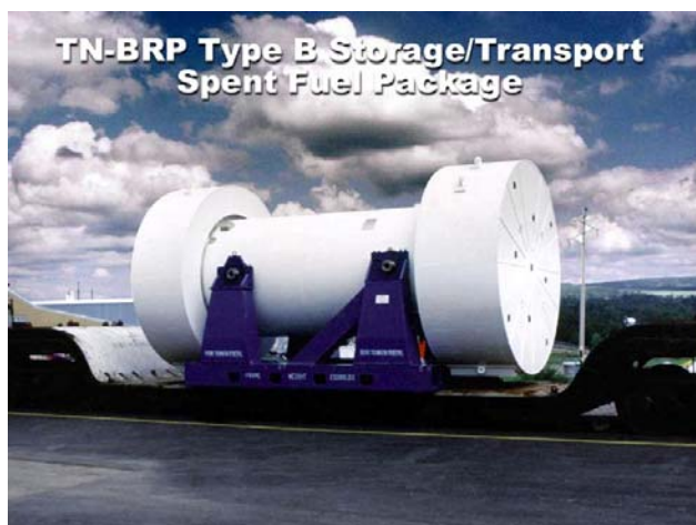
Rys. 9. 26 Pojemnik typu B stosowany do przewozu odpadów radioaktywnych o dużej aktywności, np. wypalonego paliwa. Wymagana odporność na wszystkie testy omówione powyżej. Długość pojemnika około 6 m, średnica 1,6 m, waga 82 tony.
