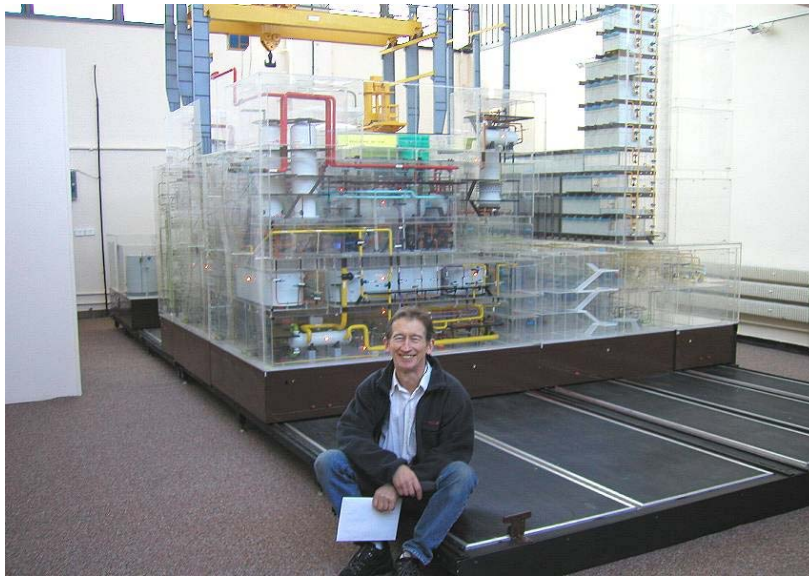
Rys. 8.12 Model elektrowni WWR-440 eksponowany w IPJ w Świerku. Z prawej strony widać wyraźnie wieżę likwidacji nadciśnienia awaryjnego. Na froncie p. Tadeusz Sworobowicz – jeden z techników pracujących przy rekonstrukcji modelu.
