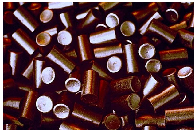
Rys. 6.13 Pastylka paliwa (z lewej). Przed dalszym wykorzystaniem pastylki są zamykane w obudowę ceramiczną (z prawej) 7 .
