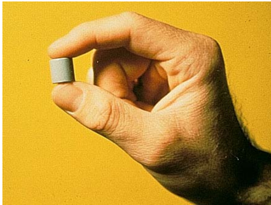
Rys. 6.13 Pastylka paliwa (z lewej). Przed dalszym wykorzystaniem pastylki są zamykane w obudowę ceramiczną (z prawej) 7 .
