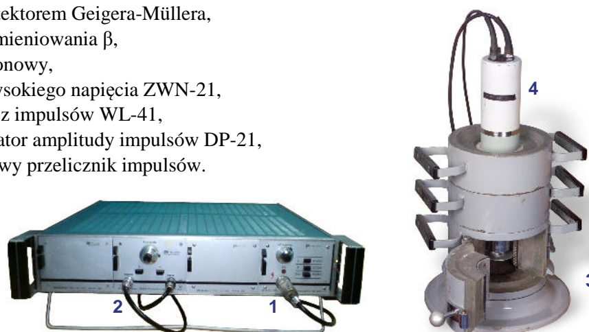
Rys. 1 Aparatura pomiarowa (1 - zasilacz ZWN-21, 2 - dyskryminator DP-21, 3 - domek osłonowy, 4 - detektor G-M)
