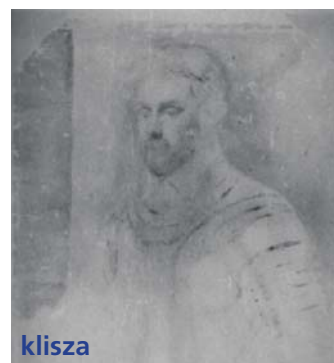
Obraz Tintoretta - zastosowanie radiografii neutronowej
