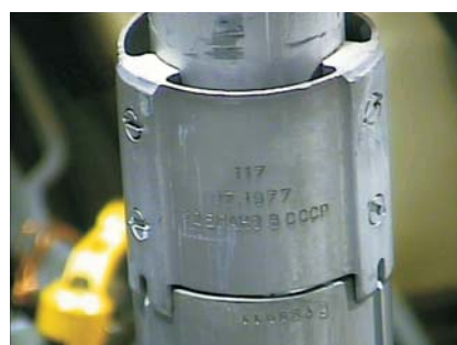
Zestaw paliwowy wkładany do kapsuły
