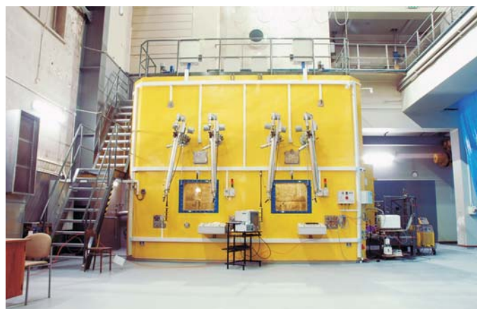
Komory do kapsulowania paliwa, znajdujące się w hali wyłączzonego z eksploatacji reaktora EWA w Świerku, widok z zewnątrz
